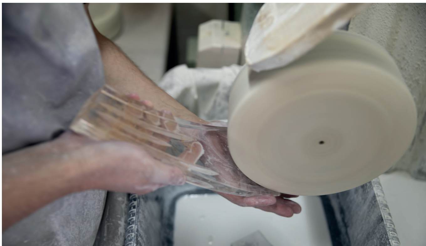
Skleněná plastika prochází mimo jiné procesem broušení a leštění.
