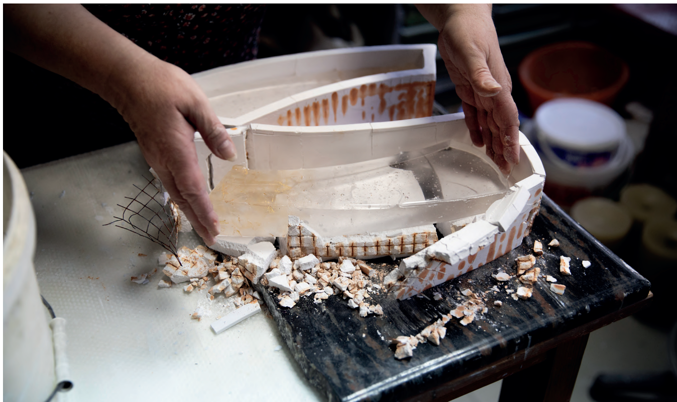
Bylo třeba vyrobit formy, ze směsi sklářského písku a sádry, natolik odolné, aby vydržely vysoké teploty.
